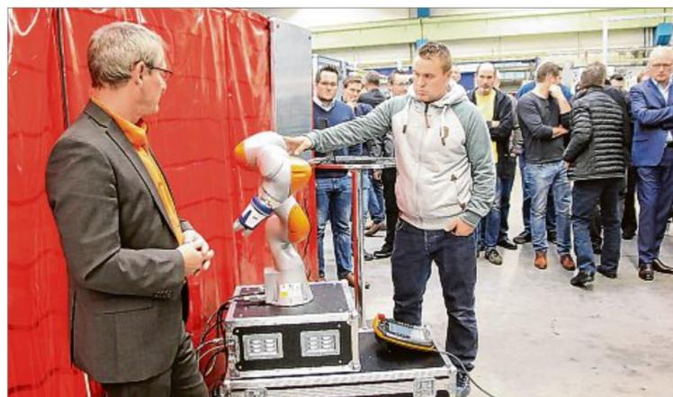
Auf Tuchfühlung mit einem neuen Cobot: Bei Berührung stoppt der kleine Roboter seine Bewegung sofort, sodass eine Gefährdung des Menschen ausgeschlossen ist. Foto: TIME
